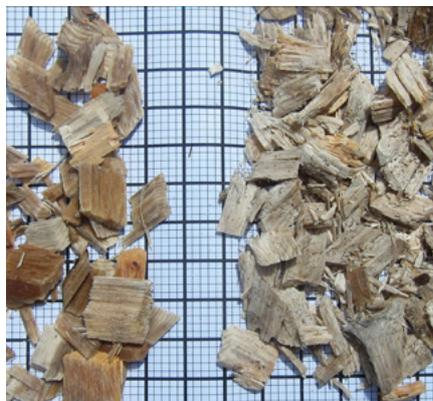
Die Holzstruktur wird während des Pressvorganges aufgebrochen, was Farbe, Homogenität und Festigkeit der Pellets verbessert
